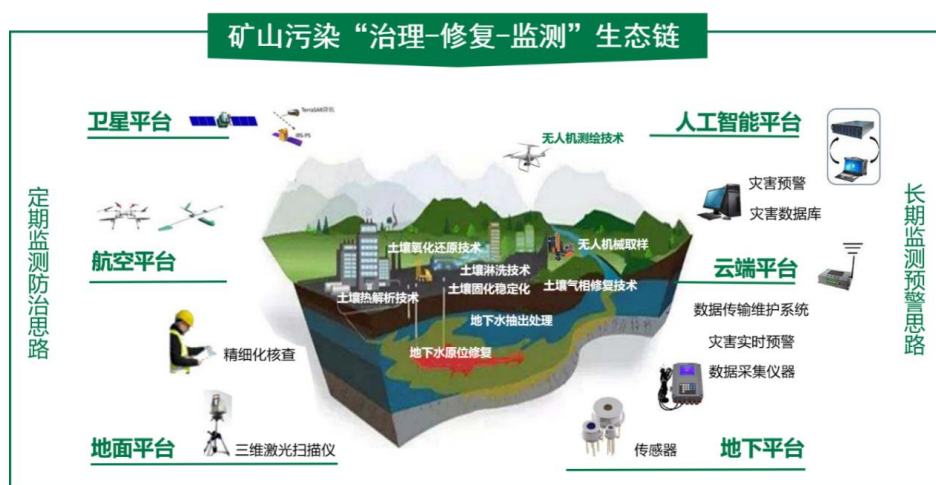
土壤污染“治理-修复-监测”生态链
